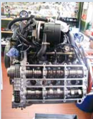
Investitionen in Langlebigkeit: bei Dr. Schrick gefertigte Spezial-Nockenwellen mit höheren Nockenhuben
