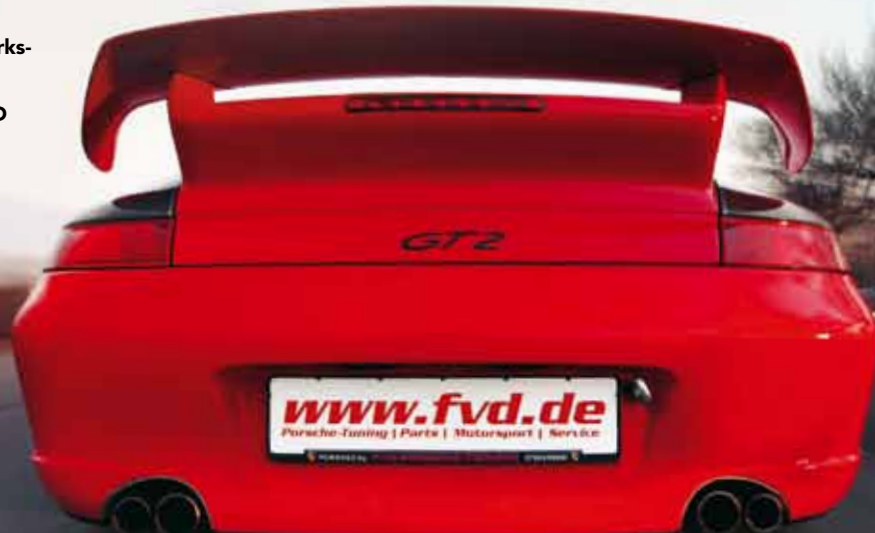
Zweiflütig hoch zwei: Die Endrohre der Abgasanlage aus Edelstahl sind jeweils zu doppelten Paketen zusammengefasst
